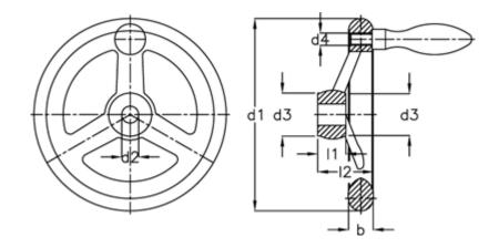
b = 26 d1 = 250 d2 H7 = 24 d3 = 45 d4 = M 12 Handle  $\overline{\phantom{a}}$  = 32 l1 = 28 l2 = 50
